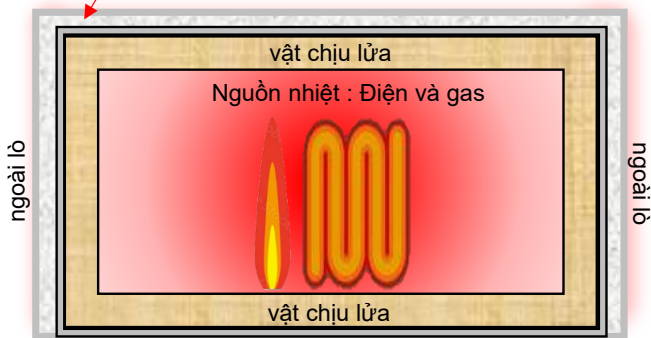
Bản vẽ mặt cắt lò công nghiệp
