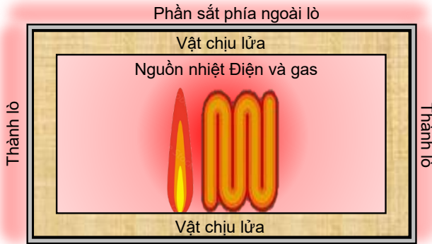
Bản vẽ mặt cắt lò công nghiệp
